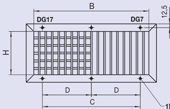
1) Schraubenlöcher  $\varnothing 4.8 \times 90^\circ$  versenkt
