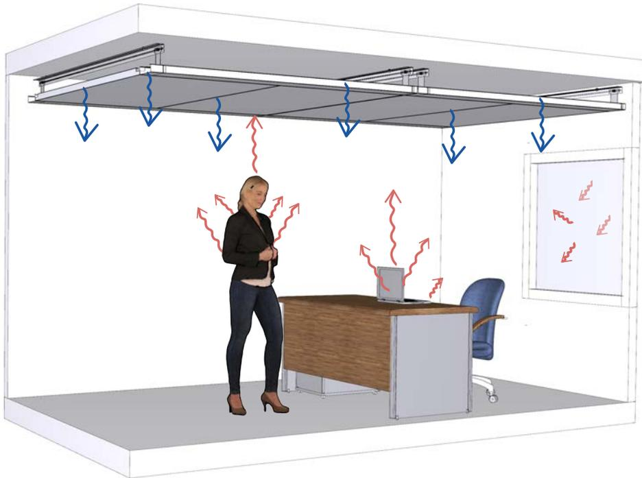
Konvektionsprinzip von auf Spalt verlegten Konvektionskühldecken (z. B. WK-D-WF)
