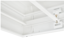
Messrohr innen zur Probenahme für Partikelmessung
