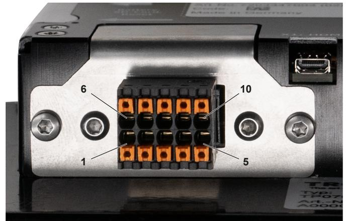
Abb. 22: Belegung des Display-Anschlusses
