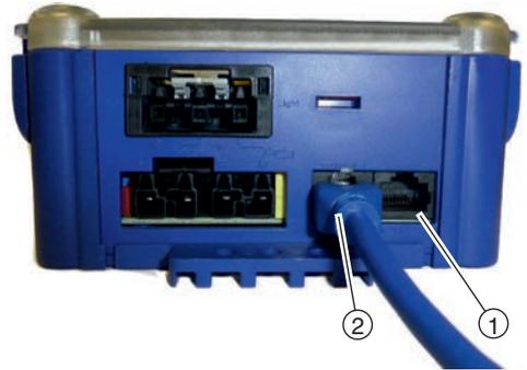
Abb. 6: Anschluss Überwachungseinrichtung FMS
