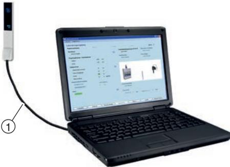
Abb. 7: Verbindungsaufbau mit EASYLAB-Konfigurationsleitung
