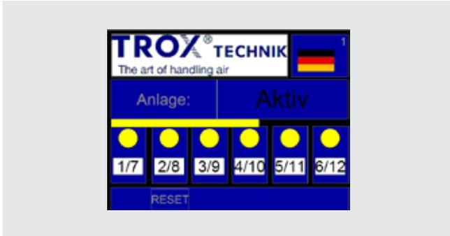
Initialisierungsphase nach dem Einschalten der Steuerung
