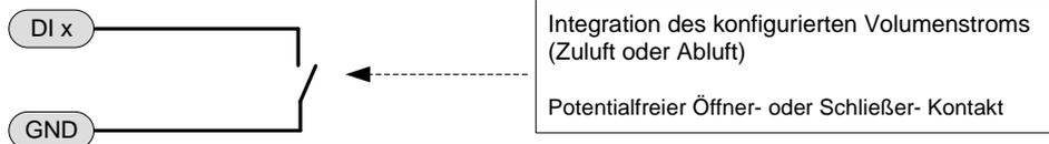
Hinweise: DIx: die Funktion kann mittels EasyConnect Konfigurationssoftware auf allen freien Digitaleingängen aktiviert werden.
