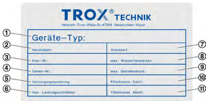
Abb. 31: Das Typenschild, befindet sich auf dem Gerätedeckel.
