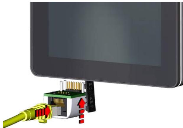
Anschluss Regler TCU3 oder Adaptermodul TAM: CP-TOUCH mit Buchse ① oder ② verbinden. Die verbleibende Buchse ist für eine 2. Bedieneinheit vorgesehen.
